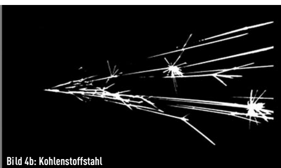
Bild 4: Funkenproben am Schleifstein. Interessante Beispiele für Stahlfunken beim Schleifen finden sich auch auf YouTube unter gelaweb-Code 20110343 .
