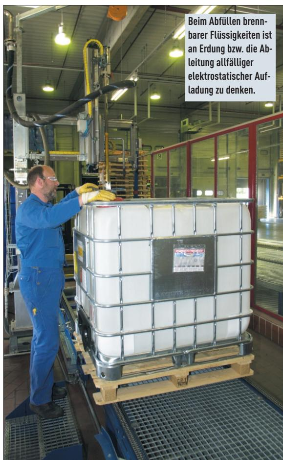
Beim Abfüllen brennbarer Flüssigkeiten ist an Erdung bzw. die Ableitung allfälliger elektrostatischer Aufladung zu denken.
